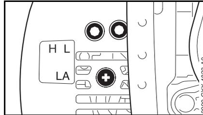
Toto seřízení karburátoru je provedeno tak, že je do motoru za všech provozních podmínek přiváděna optimální směs paliva a vzduchu.
